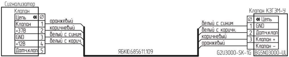
Рисунок В.4 – Схема подключения клапана КЗГЭМ-У с разъемом BG5NO3000-UL.
